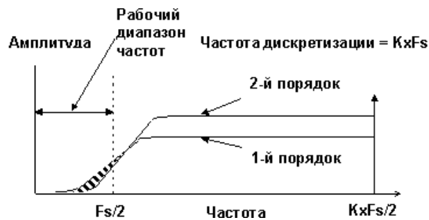
Рис.2.15 Функции распределения спектра шума для модуляторов первого и второго порядка.
